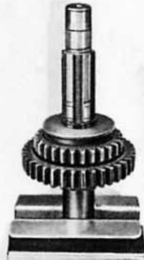
Nun schiebt man das nächst größere Zahnrad ohne Keilnuten (30 Zähne, 4. Gang) so auf, daß die Klauen nach oben zeigen, worauf wieder eine Anlaufscheibe und ein Sicherungsring folgt (s. Bild 22).
