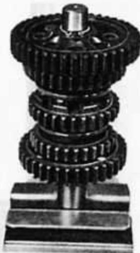
Schließlich wird das größte Zahnrad ohne Keilnuten (42 Zähne, 1. Gang) an der Kennrinne nach oben aufgeschoben (s. Bild 24).
